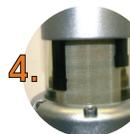
I modelli da DN65 a DN100 hanno un'unica calza filtrante, il modello DN125 ha 2 calze filtranti, il modello DN 150 ha 3 calze filtranti e il modello DN 200 ha 4 calze filtranti.
